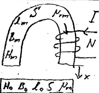
Lägg in ett luftgap med längd  $x$ .
