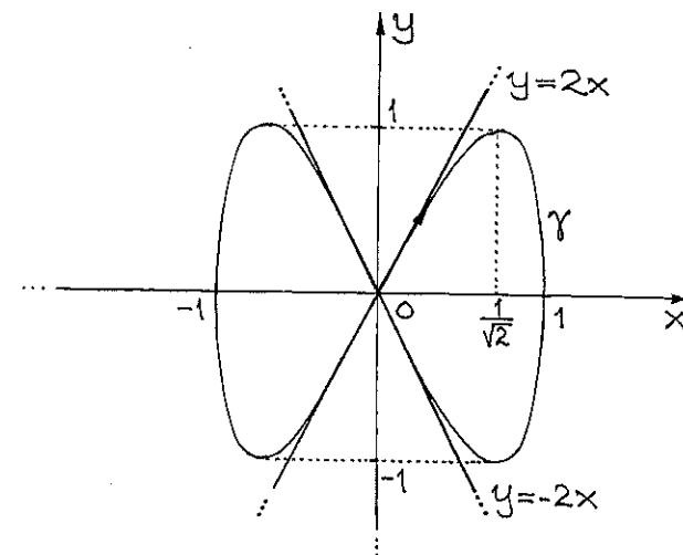
Kurvan är en sk. Lissajou /lisa'zu/ figur och kan avbildas (triggas) på oscilloskopsskärmen.
