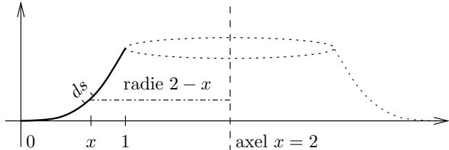
När bågelementet  $ds = ds(x)$  vid  $x$  roterar kring axeln  $x = 2$  skapar det ett cirkulärt band med radie  $r(x) = 2 - x$  och sned kantlängd  $ds(x)$  och därmed area  $dA(x) = 2\pi r(x) ds(x)$ . Vi får därför att arean av rotationsytan är
