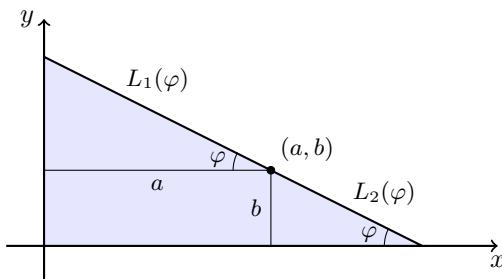
Hypotenusans längd är alltså  $L(\varphi) = L_1(\varphi) + L_2(\varphi) = a/\cos \varphi + b/\sin \varphi$ , och vi söker det minsta värdet på detta uttryck när vinkeln  $\varphi$  varierar i intervallet  $0 < \varphi < \pi/2$ . Derivering ger
