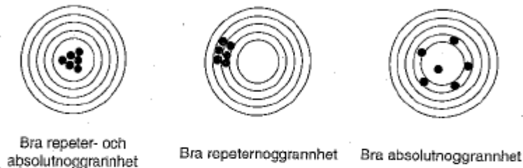
Figur 12.3 Beskrivning av repeter- och absolutnoggrannhet.
